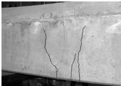
Fessure provocate da flessione eccessiva.
