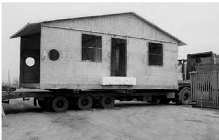
Figura 1.10 - Prototipo di casa mobile realizzata con pannello singolo portante.
